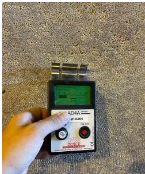
Obr. 13 Kontrola kvality, meranie vlhkosti podkladu
