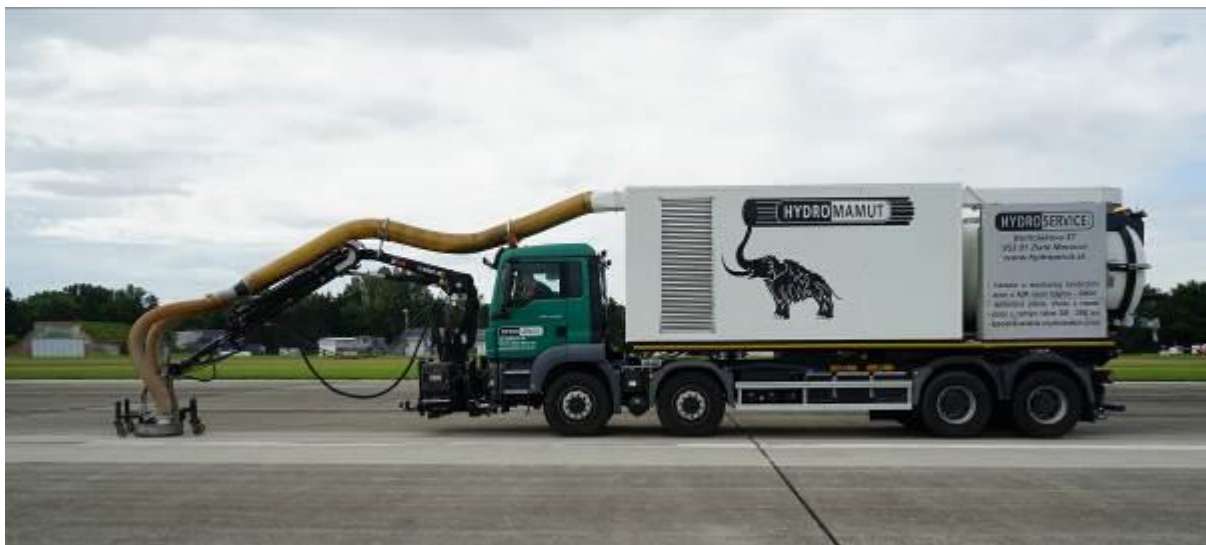
Obr. 1 „Hydromamut“ – veľkoplošné otryskávacie vozidlo
